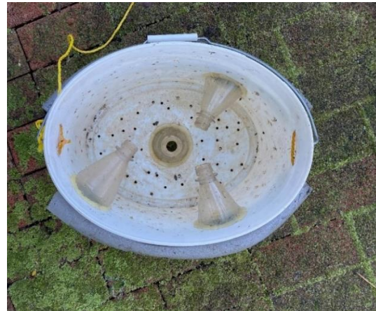
Abbildung 3: Innenansicht der Eimerreuse mit den nach innen gerichteten PET-Flaschen, 18.01.2023 Foto: L. Schasiepen
