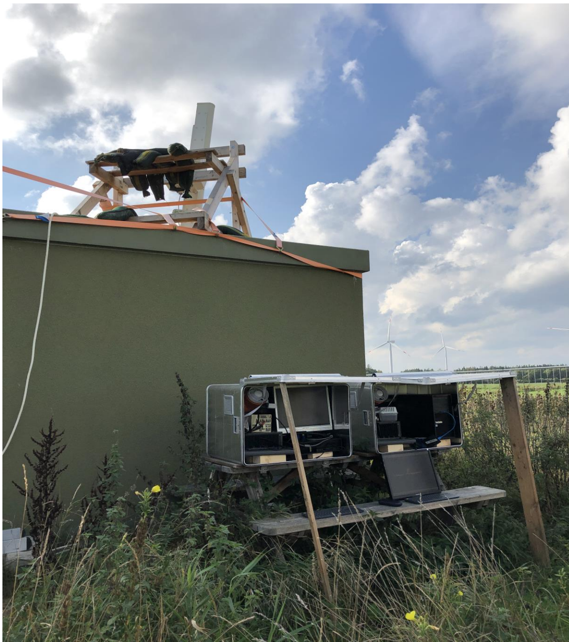
Abb. 3.7 Die beiden geöffneten Aluminiumboxen mit dem Prozessor und weiteren Systemkomponenten am Radarstandort (Quelle: Dr. Jorg Welcker, Mitarbeiter von BioConsult SH).
