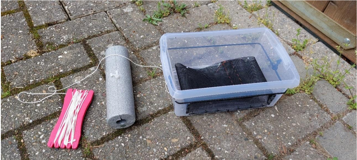
Abb. 2.2: Dewsbury Reuse mit Schaumstoffschwimmer und Einholschnur (Eigenes Foto)
